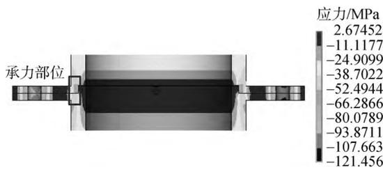
图 18 压缩载荷下止口螺栓连接结构的应力应变图
