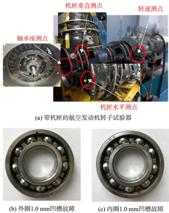
图 9 模拟试验器及预设故障
