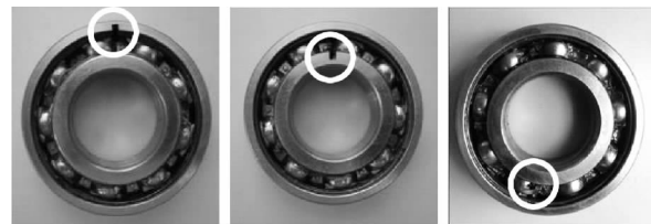
(a) 外圈故障 (b) 内圈故障 (c) 滚动体故障
