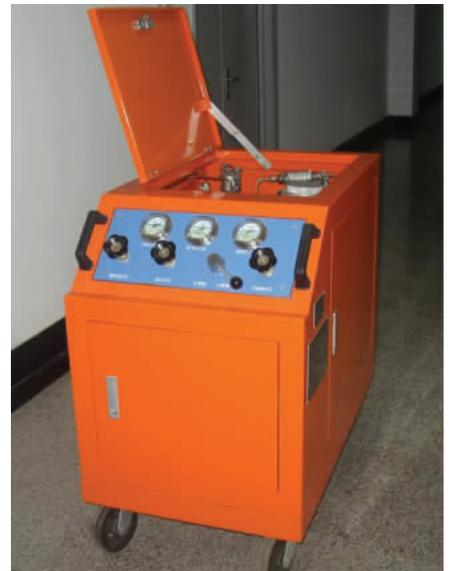
图2 油滤磨屑自动清洗收集装置
