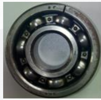
被试外圈故障轴承
