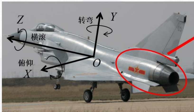
飞机和发动机坐标系示意图
