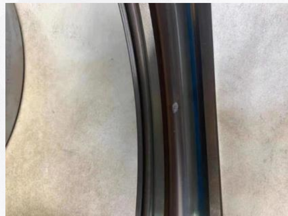
滚动轴承外圈剥落
