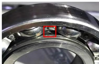
图 12 内滚道存在初始剥落的轴承
