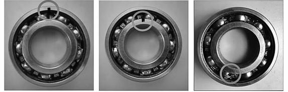
(a) 外圈故障 (b) 内圈故障 (c) 滚动体故障
