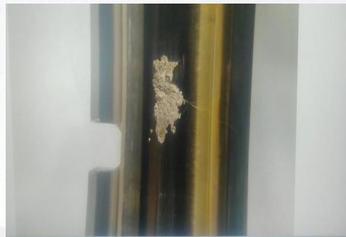
三支点主轴承剥落实物图
