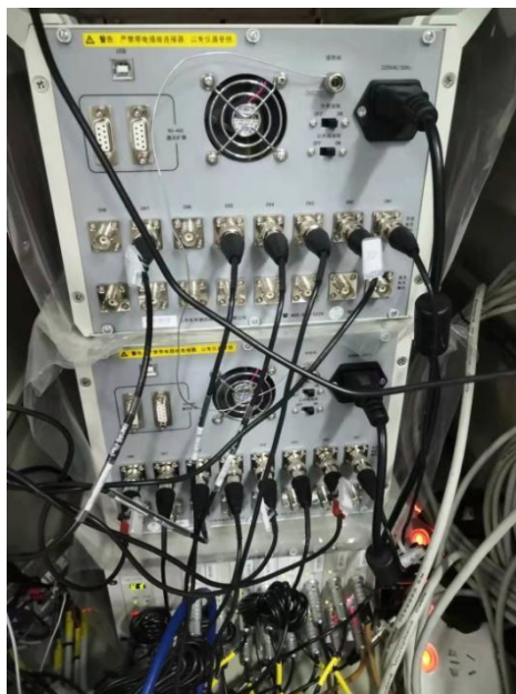
图 5.4 东华 8302 型数据采集器实物图
