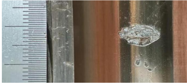
图 5.16 主轴承疲劳剥落故障
