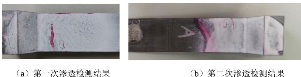
图 5.4 直板叶片渗透检测结果
