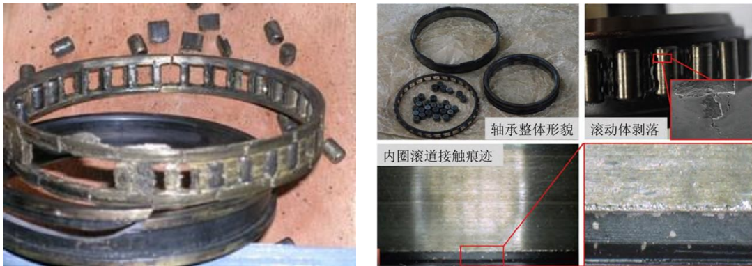
图 1.2 航空发动机中介主轴承损伤情况
