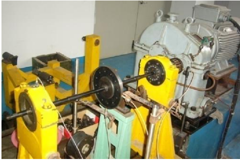
图1 转子-滚动轴承故障试验器
