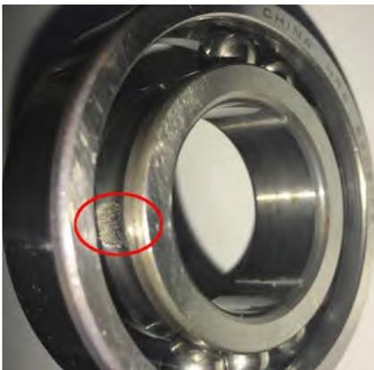
图21 轴承2剥落图
