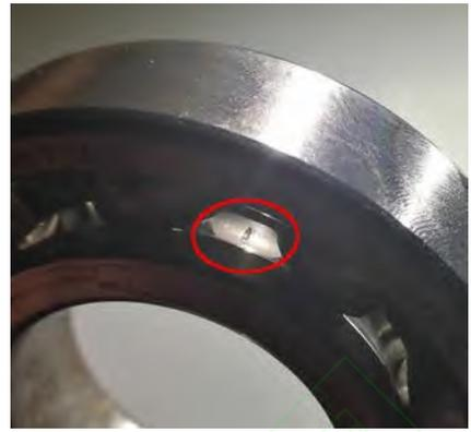
图22 轴承3剥落图
