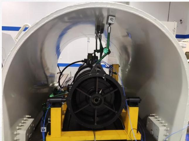
Y方向叶尖间隙测点
