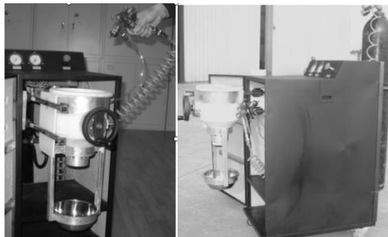
图1 滑油滤清洗和磨屑收集系统实物
