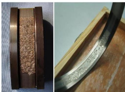
图 1.1 某型航空发动机主轴承失效的典例照片
