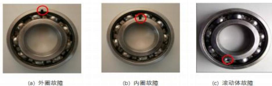
图 2.4 航空发动机转子试验器 6206 滚动轴承故障
