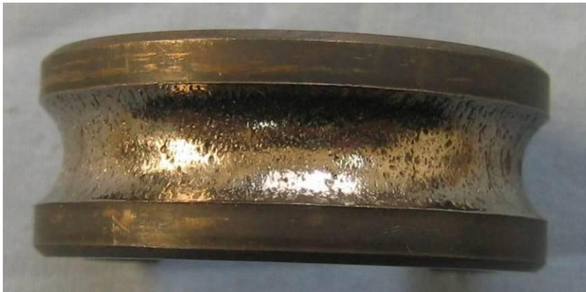
图 2.16 内套圈滚道上的滚动接触疲劳花样
