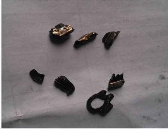
图 3.29 主滑油泵内金属片
