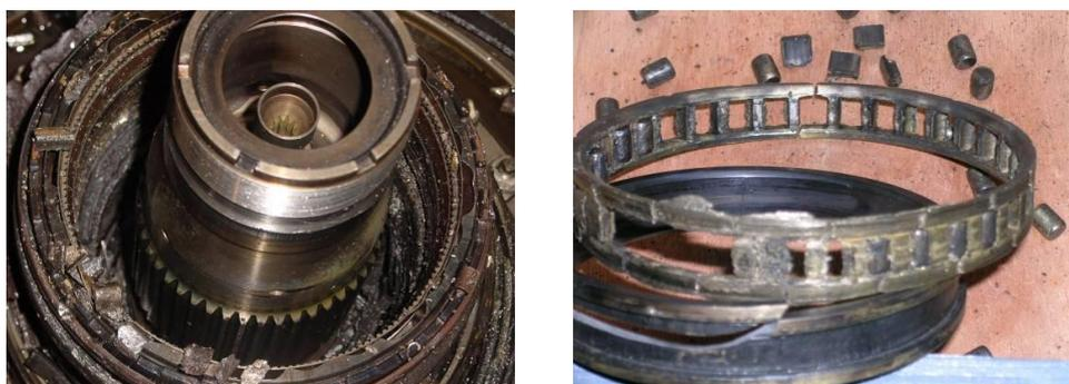
图 1.2 航空发动机主轴轴承磨损抱轴失效
