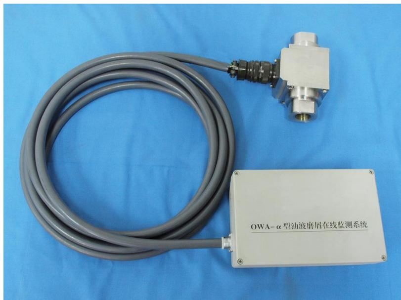
图 4.7 油液磨屑在线监测系统样机
