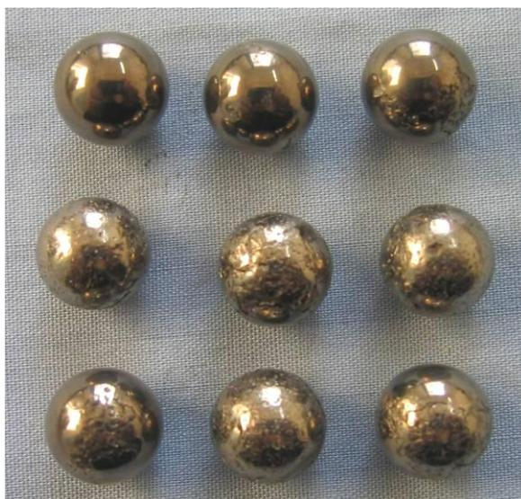
图 2.18 失效轴承分解后滚珠形貌
