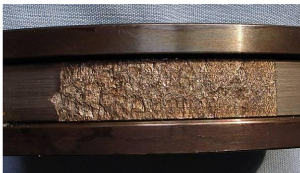
图 2.8 轴承内套圈上长约 35mm 的剥落
