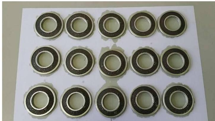
图 2.37 滑油滤上的金属屑外观
