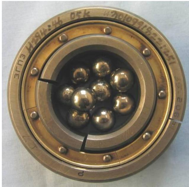
图 2.14 失效轴承分解后形貌
