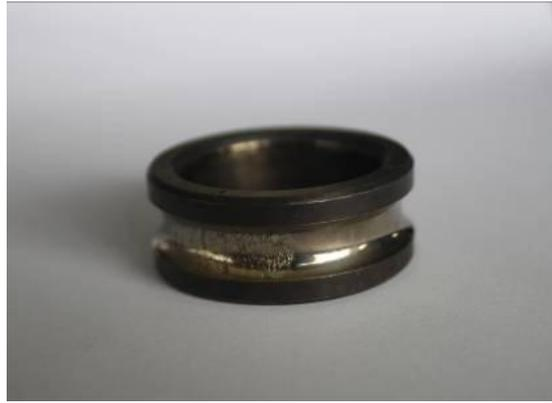
图 2.6 轴承内钢套滚道上 1/2 圆周连续剥落
