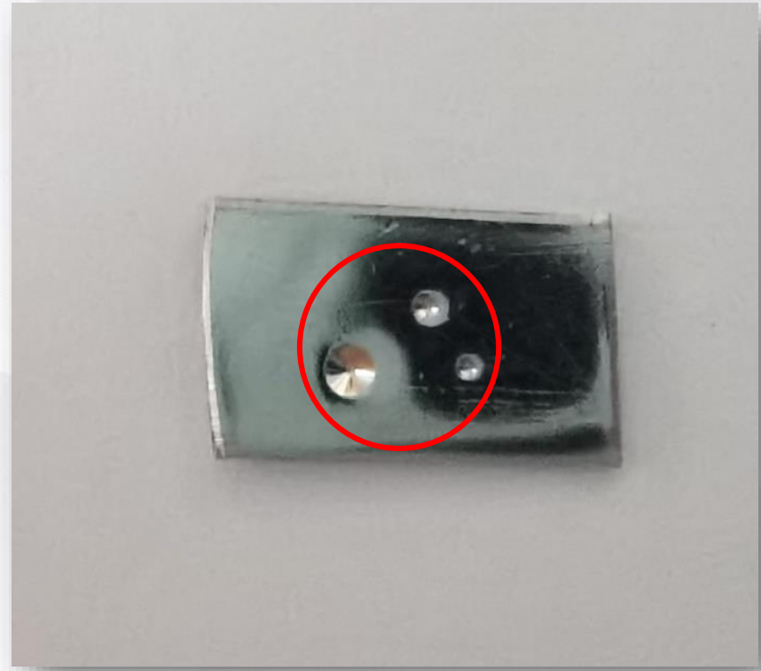
采用硬度计对试件表面进行 挤压后形成的点状凹坑
