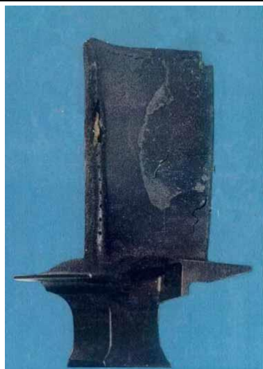
(图 a) 涡轮叶片掉块
