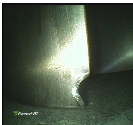
(图 c) 压气机叶片缺损
