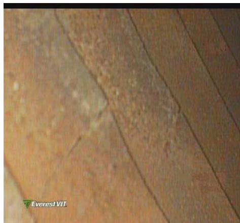
(图 d) 燃烧室机匣弯曲形变
