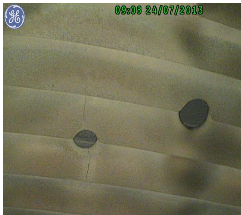
(图 a) 燃烧室机匣溶解
