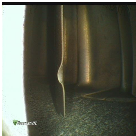
(图 a) 压气机叶片弯曲形变
