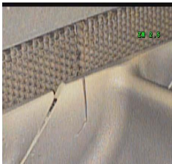
(图 b) 涡轮叶片裂痕
