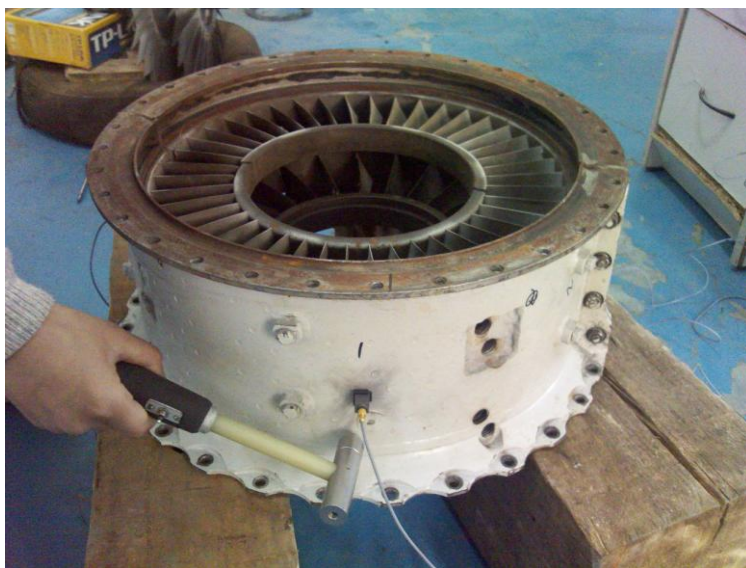
图 4.9 中机匣锤击法实验图
