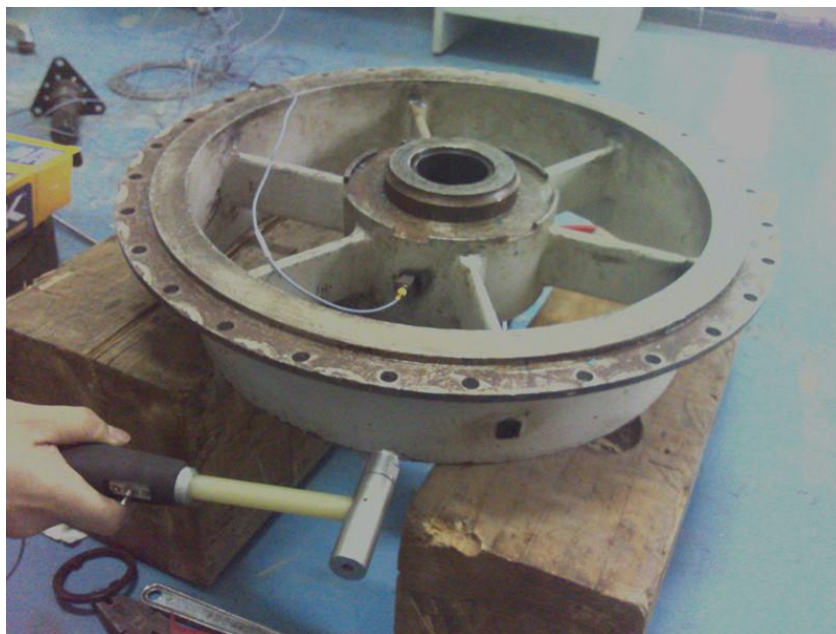
图 4.5 前机匣锤击法实验图
