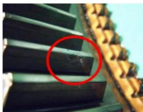
图 1.3 齿轮箱齿轮断裂
