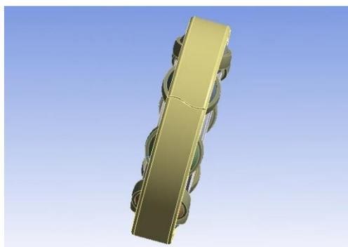
图 3.4 故障滚动轴承的几何模型
