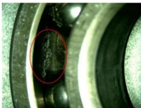
图 1.2 发动机主轴承剥落
