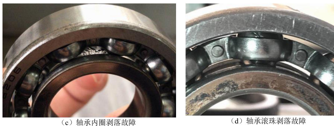
图 A.9 油液磨屑在线检测系统及轴承剥落形貌图
