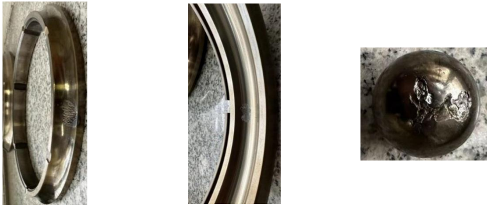
(b) 三支点内圈、外圈和球预置故障情况
