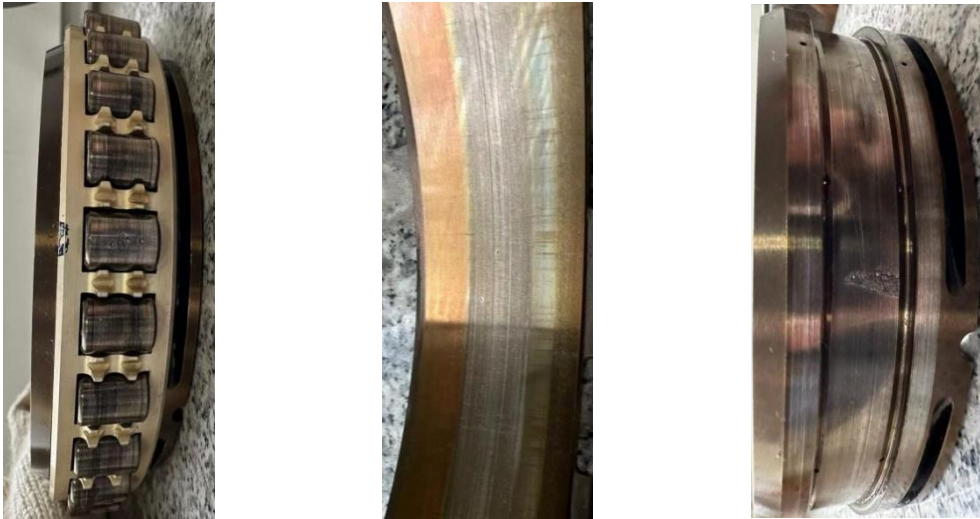
(a) 四支点滚动体、外圈和内圈预置故障情况
