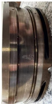
四支点滚动体、外圈和内圈预置故障情况
