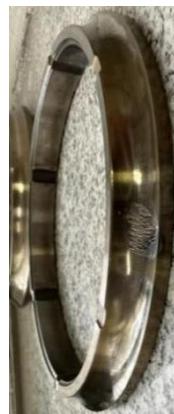
三支点内圈、外圈和球预置故障情况
