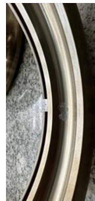
三支点内圈、外圈和球预置故障情况
