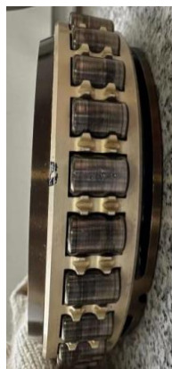
四支点滚动体、外圈和内圈预置故障情况
