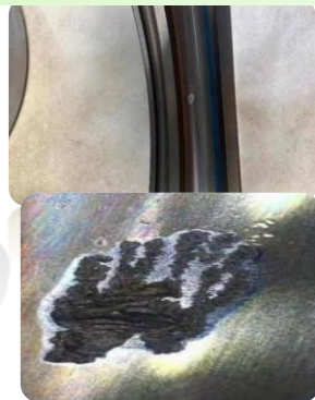
航空发动机的主轴承故障
