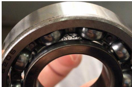
轴承内圈剥落故障
