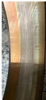
四支点滚动体、外圈和内圈预置故障情况
