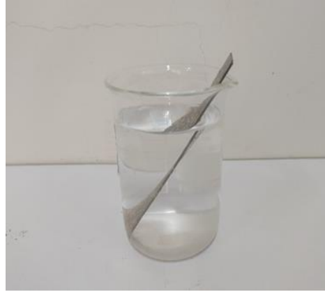
图 3.24 样片耐盐水试验过程中
