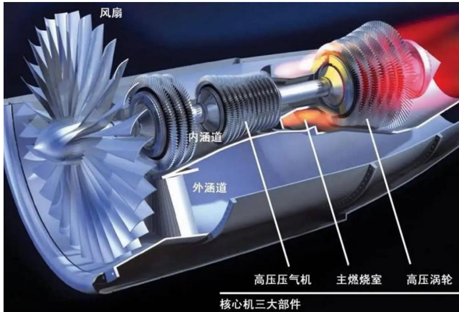
图 3.4 高压涡轮故障发生区域
