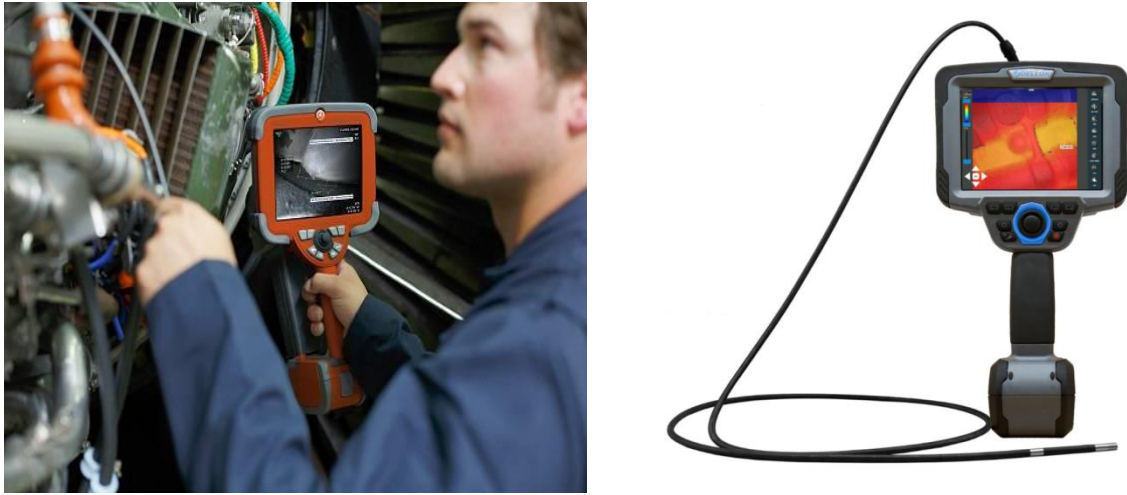
图 1.4 工程师在使用孔探仪检查发动机
