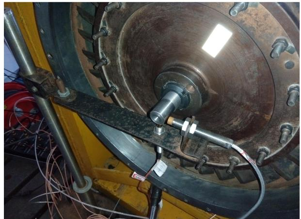
图 4.7 涡轮端转轴测点分布图
