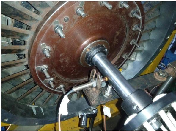
图 4.6 压气机端转轴测点分布图
