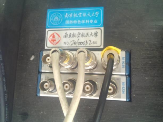
图 5.6 NI USB-9234 数据采集卡
