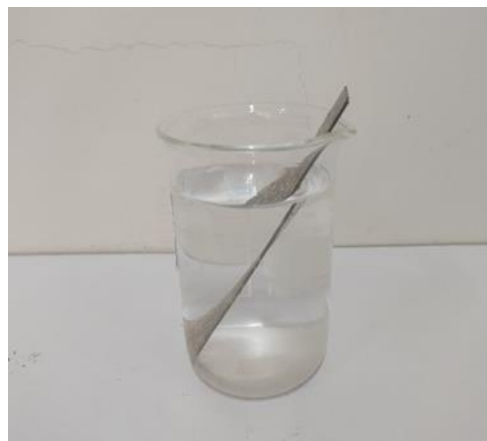
图 4.6 样片耐盐水试验过程中
