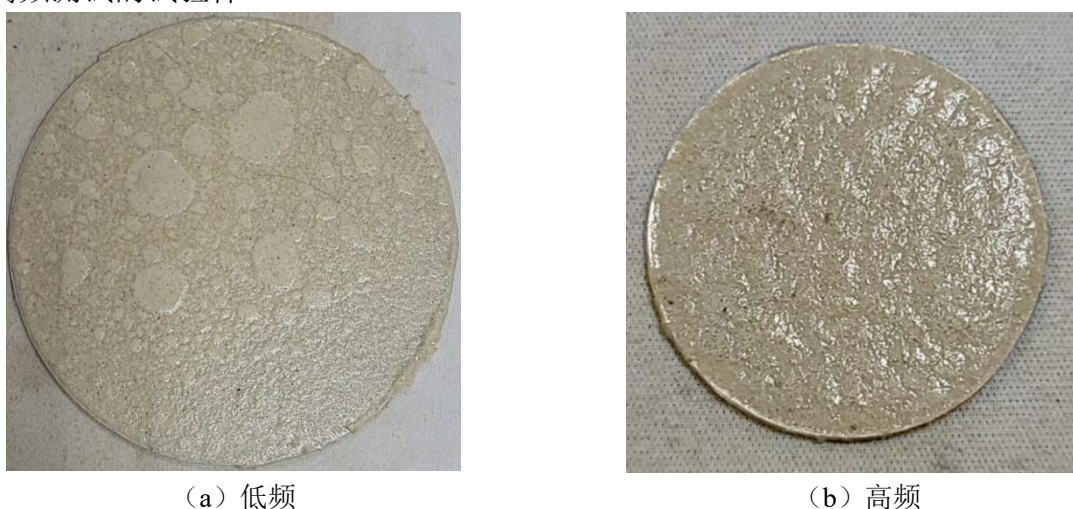
图 3.10 小尺寸中填料含量 (40%) 减振降噪涂层试验样片
