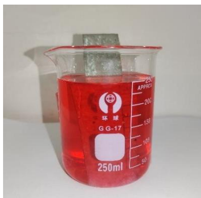
图 4.9 样片耐液压油试验过程中
