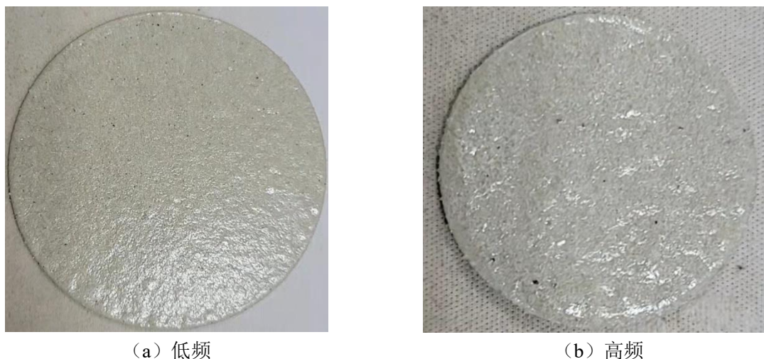
图 3.4 中尺寸中填料含量（40%）减振降噪涂层试验样片
