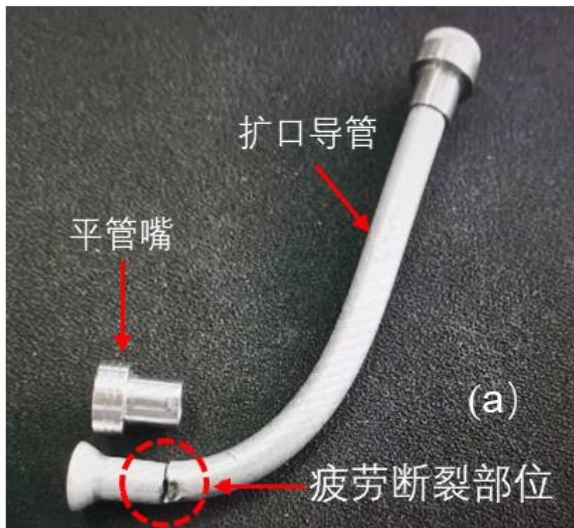
扩口导管与平管嘴末端接触部位
