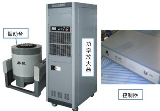
图 2.4 苏试 DC-300 型电动振动台
