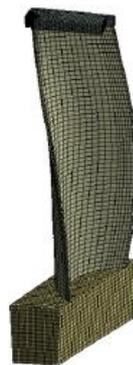
图 1.2 叶片结构场网络划分
