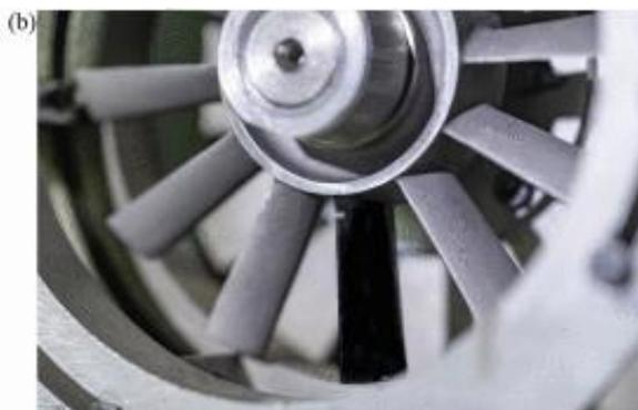
图 1.2 含裂纹的叶盘
