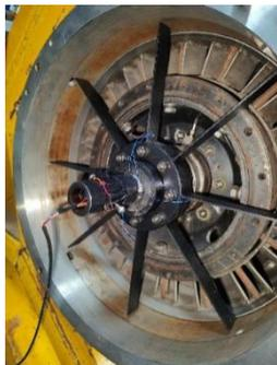
图 3.2 叶片应力测量
