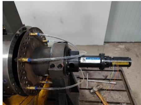
图 3.2 气流激励装置实物图
