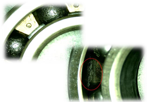
某型发动机附件机匣轴承剥落导致发动机故障
