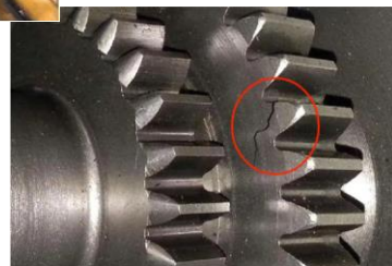
某型发动机中央齿轮箱齿轮断裂
