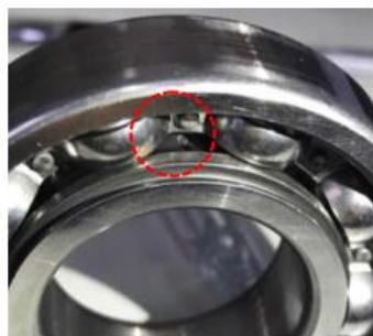
(a) 1号剥落轴承, N=2.10 \times 10^8 2.50 mm
