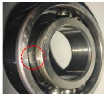
(b) 2号剥落轴承, N=2.64 \times 10^8 8.50 mm
