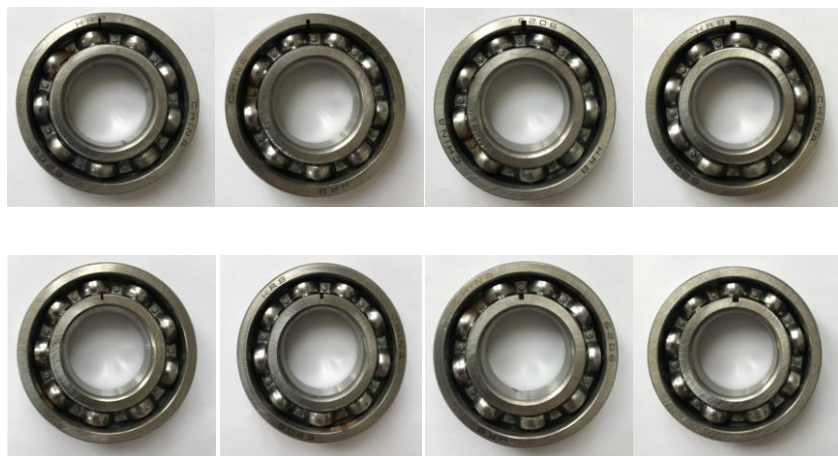
内外滚道上有局部损伤的故障轴承 (1.0mm, 1.4mm, 1.8mm, 2.2mm)
