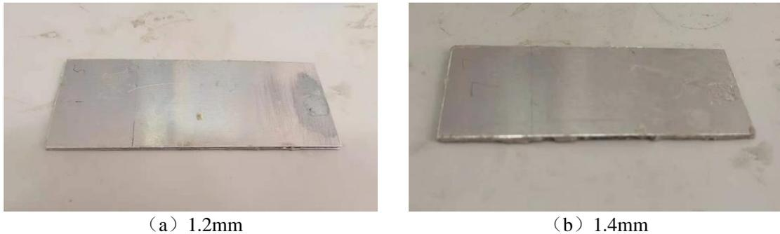
图 4.2 填料为 10 目云母粉固体含量为 20% 制得的水性阻尼减振涂层附约束层试验件
