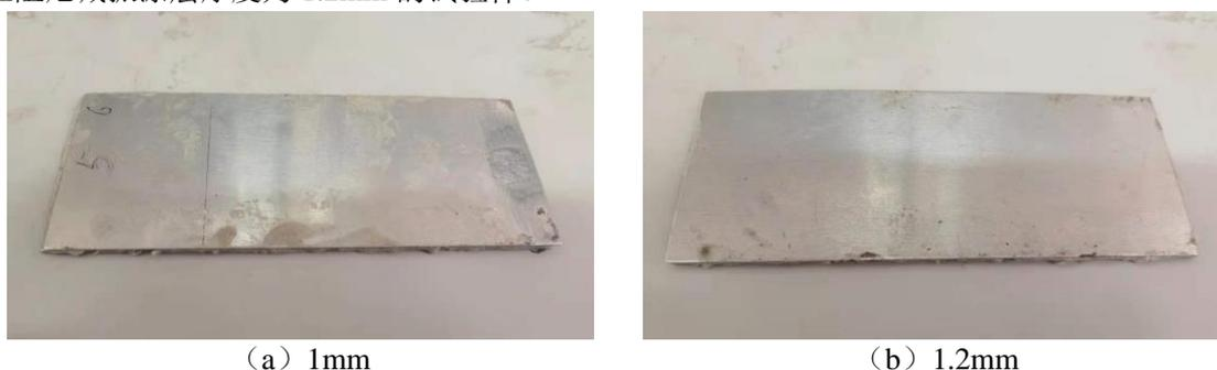
图 4.9 填料为 40 目云母粉固体含量为 20% 制得的水性阻尼减振涂层附约束层试验件
