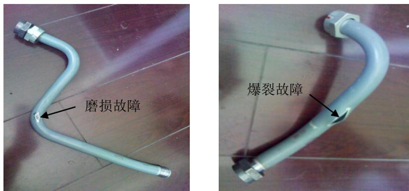
图 1.1 为国内某型飞机液压导管故障图。
