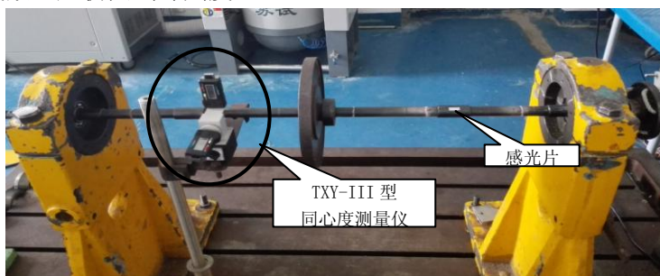
图 3.19 百分表测量转子弯曲实物图
