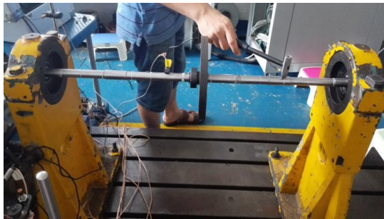
图 2.9 转子-滚动轴承试验器模态试验现场图
