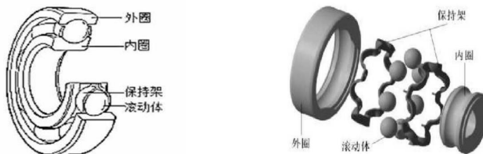
图 2.4 滚动轴承的结构图
