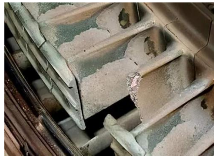
发动机叶片的蠕变断裂
