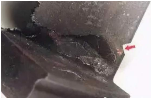
发动机叶片根部疲劳裂纹扩展
