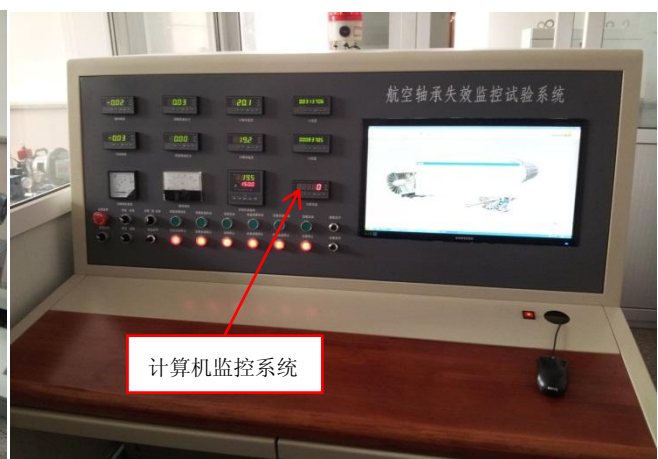
图 3.2 航空轴承失效监控试验系统控制面板
